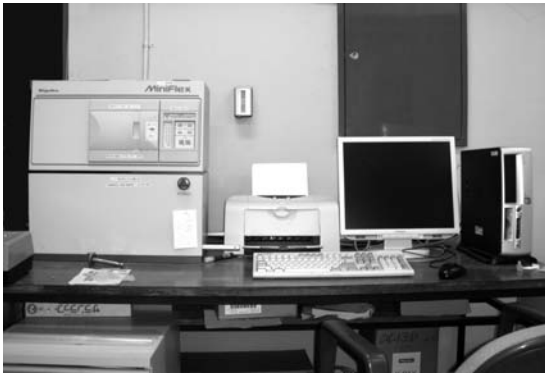
図 5. 名古屋大学年代測定総合研究センターの理学 MiniFlex X 線回折計。
