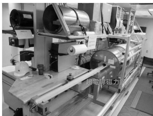
写真 2. 船内実験室のパススルー型超電導磁力計(2G Enterprises model 760-R)。半割コアの残留磁化測定と交流消磁が可能。
