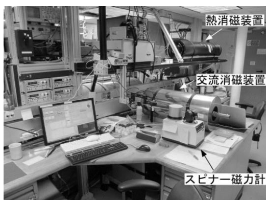
写真 3. 船内実験室のスピナー磁力計(AGICO JR-6A)と消磁装置(交流消磁, 熱消磁)。
